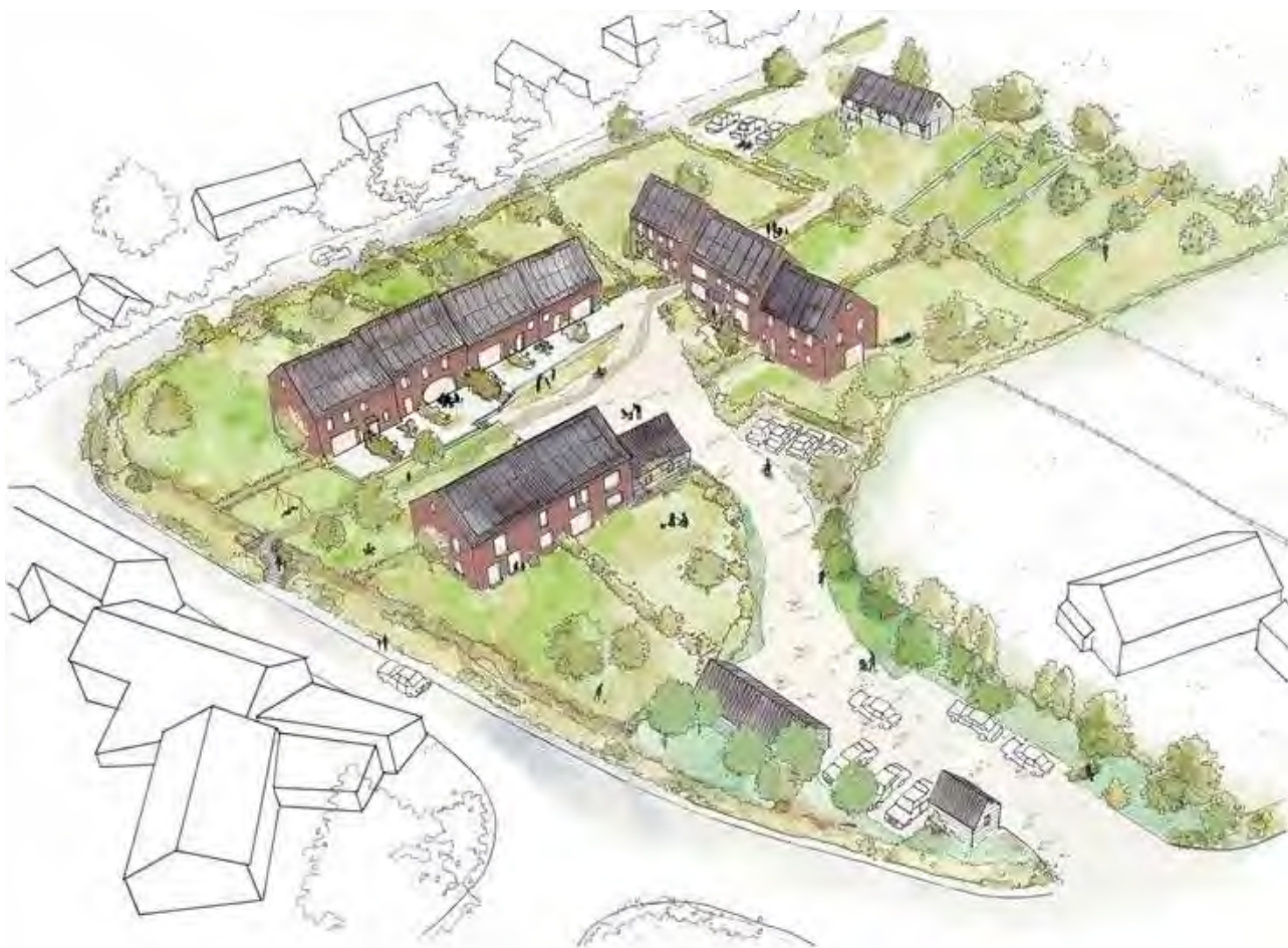
Illustration 13: une parcelle transformée en habitat groupé par un promoteur à Chaumont-Gistoux. La situation de la parcelle empêchait un lotissement classique car certains espaces n'étaient pas accessibles par la voirie.
